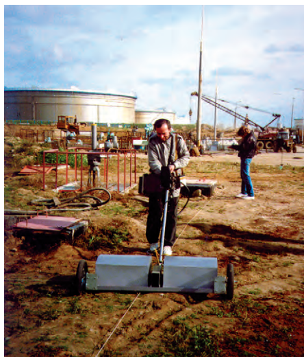
Рис. 4. Исследование коммуникаций на нефтеперерабатывающем предприятии
