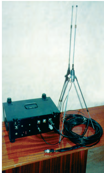
Рис. 3. Телеизмерительная станция перед установкой в вагон
