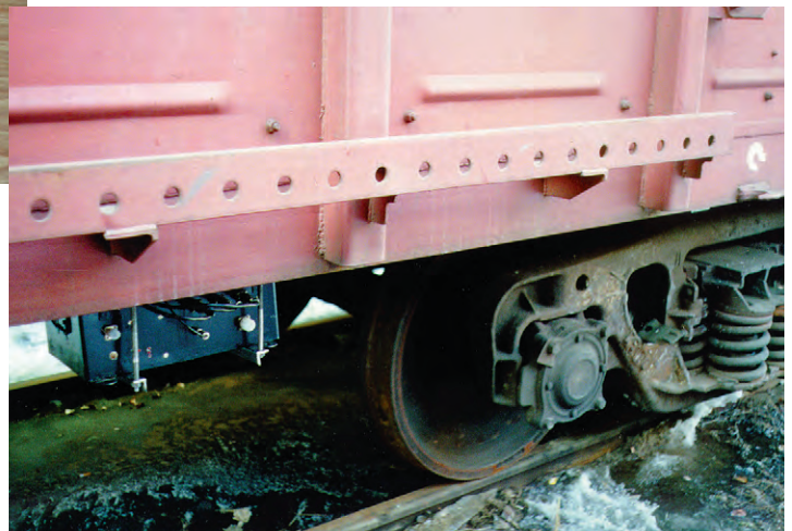
Рис. 4. Телеизмерительная станция, установленная под вагоном
