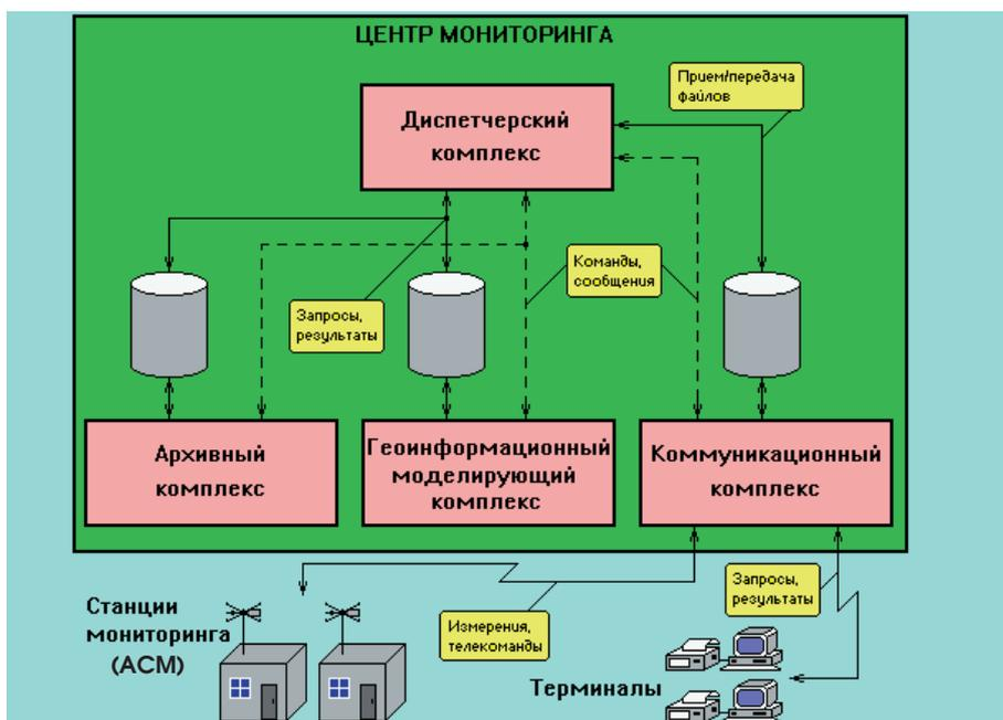
Рис. 5. Технология обработки информации в Центре мониторинга
