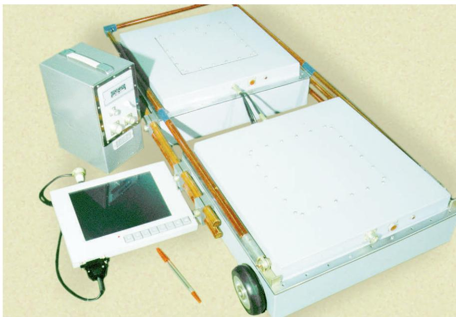
Рис. 2. Георадар для глубин до 10 м
