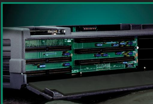
стойкость к ударам до 100g. Станция комплектуется процессорами от 486 до Pentium-166, памятью, расширяемой до 128 Мбайт, дисками емкостью до 5 Гбайт, внутренним дисководом CD-ROM, цветным 10.4" SVGA-экраном, PCMCIA-слотом, универсальным источником питания от сети и аккумуляторов, в
