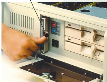
Рис. 1. Шасси промышленного компьютера IPC-610
