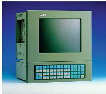
Рис. 11. MiPC-50 с подключенной клавиатурой
