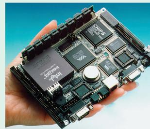
В настоящее время серия состоит из 3 моделей: PCM-4824 содержит действующий 32-битовый SVGA/LCD интерфейс с соответствующим разъемом DB-15; PCM-4822 содержит встроенный 16-битовый совместимый с NE-2000 интерфейс с Ethernet с разъемом RJ-45. Boot ROM, необходимый для удаленной загрузки, включен в системный BIOS; PCM-4820 поддерживает стандартные функции материнской платы и имеет разъем DB-25 для параллельного интерфейса.
