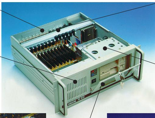
Регулируемая крепежная планка с амортизаторами предохраняет платы от ударов и вибрации
