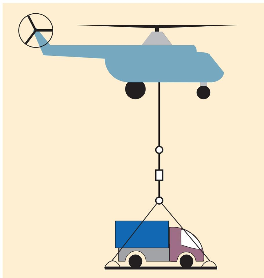
Рис. 1. Транспортировка груза на внешней подвеске вертолета
