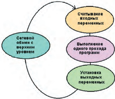
Рис. 2. Циклограмма функционирования системы исполнения на целевом контроллере
