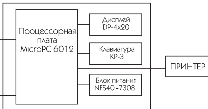
Рис. 2. Структурная схема системы «Стенкомер СЦ-50» (ТПП – тензорезисторный преобразователь перемещения, МТП – модуль тензорезисторного преобразователя).
