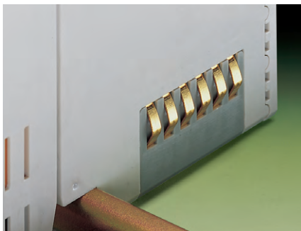
Рис. 6. Реализация шины данных в контроллере WAGO I/O-System
