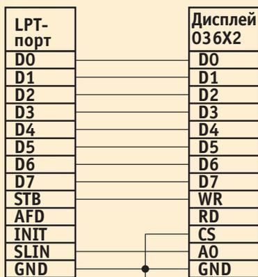
Рис. 5. Схема подключения дисплея к параллельному порту
