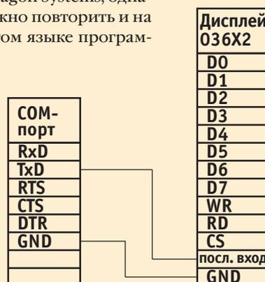
Рис. 7. Схема подключения дисплея к последовательному порту
