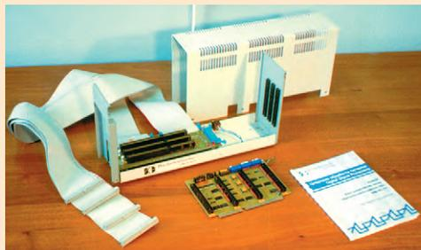
Благодаря полной буферизации PCBOX защищает PC от перегрузок и коротких замыканий. Независимое управление питанием PCBOX позволяет устанавливать модули без перезагрузки PC. Высокая помехозащищенность обеспечивает устойчивую работу дополнительных модулей при полной скорости работы шины ISA.
