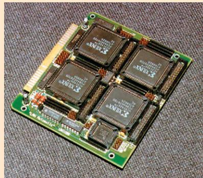
В модулях используются программируемые логические микросхемы (FPGA) и ПЗУ вариантов схем, что позволяет пользователю изменять алгоритм работы без изменения топологии платы. Модуль совместим по управлению с модулями UNIO48(24). Для облегчения программирования поставляются примеры и библиотека функций на языке C.
