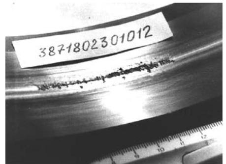
Рис. 1г. Вид поврежденной беговой дорожки наружной обоймы роликоподшипника. Максимальная стадия (незадолго до разрушения): повреждена вся поверхность беговой дорожки
