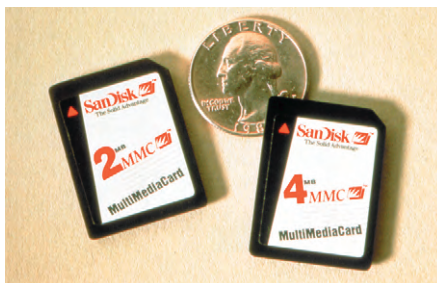
Рис. 6. Multimedia Card фирмы Sandisk
