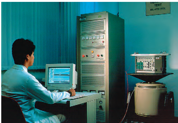
Испытание изделий на вибростойкость
