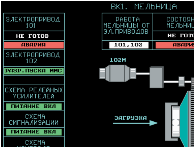
Рис. 4. Видеокادر состояния комплекса оборудования мельницы
