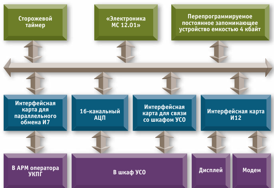
Рис. 2. Структурная схема управляющей ЭВМ «Электроника-60»
