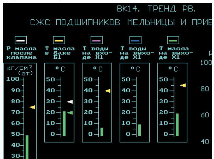
Рис. 7. Видеокادر контроля параметров СЖС подшипников мельницы и приводных шестерен
