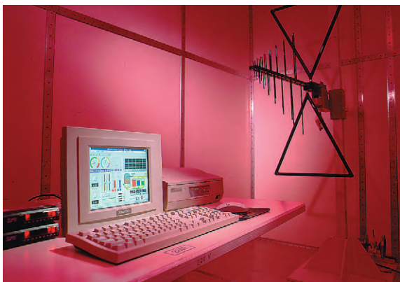
Испытание продукции на электромагнитную совместимость
