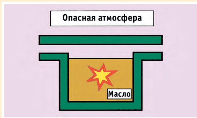
Рис. 6. Метод защиты погружением в масло
