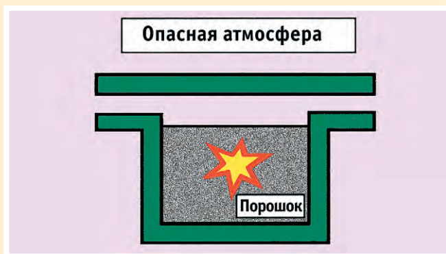
Рис. 7. Метод защиты заполнением порошком
