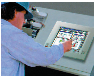
Рис. 11. Компьютер, смонтированный на панели
