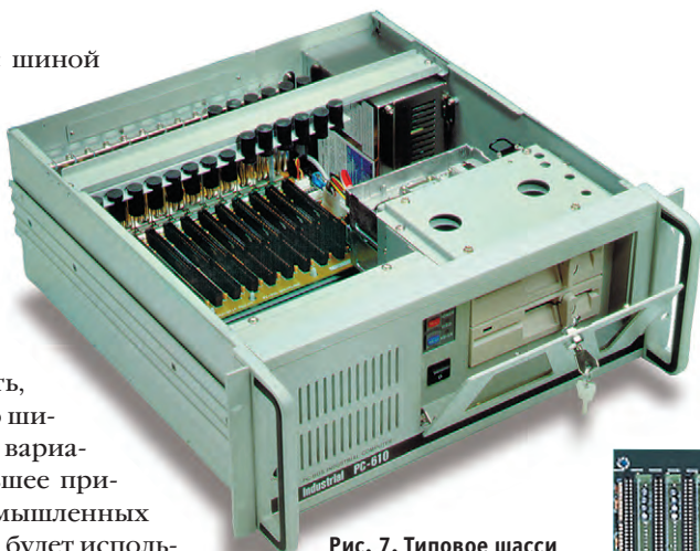
Рис. 7. Типовое шасси промышленного компьютера (Advantech IPC-610)
