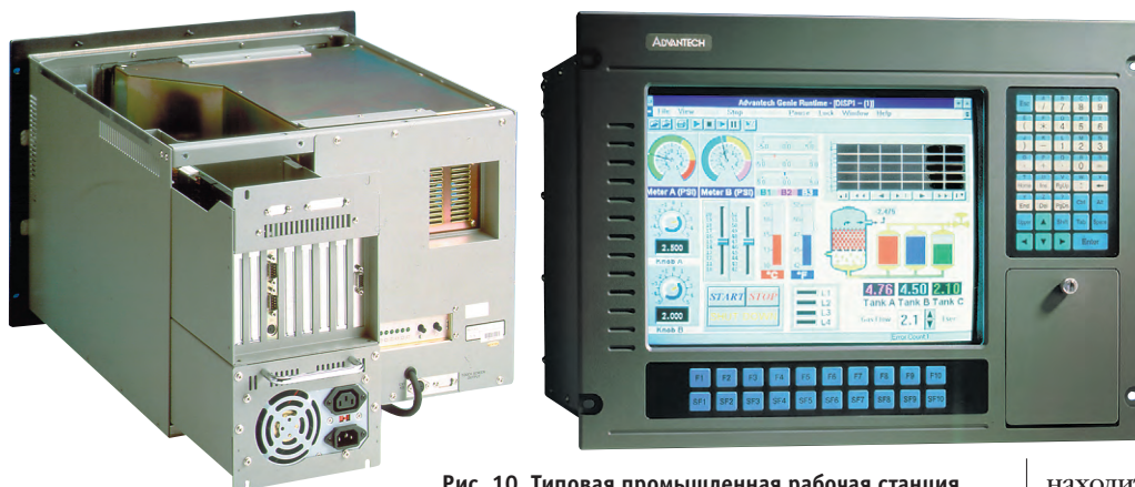
Рис. 10. Типовая промышленная рабочая станция (Advantech AWS-825)
