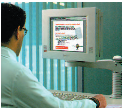
Рис. 10. Монтирование панельного компьютера на поворотной ручке
