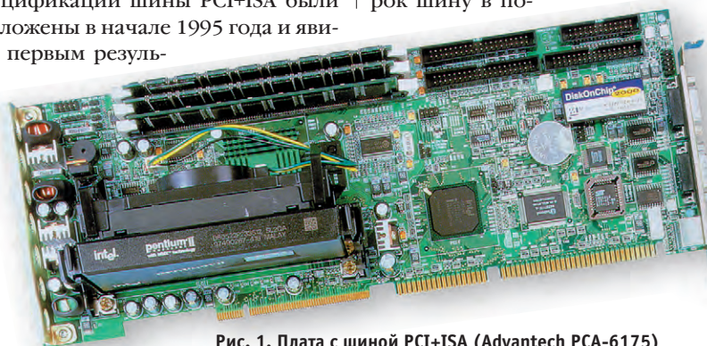
Рис. 1. Плата с шиной PCI+ISA (Advantech PCA-6175)
