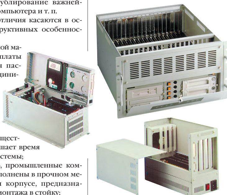
Рис. 9. Разнообразие конструктивных исполнений промышленных компьютеров (Advantech MBPC-641, IPC-622 и IPC-6806)
