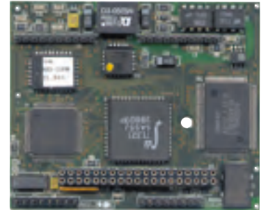
Рис. 12. Малогабаритный модуль фирмы Hilscher с интерфейсом CAN для производителей комплексного оборудования (OEM)
