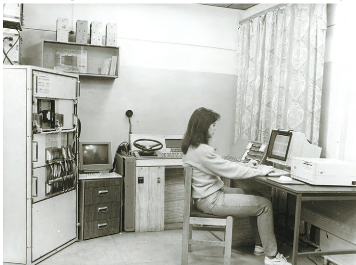
Испытание центрального блока управления (ЦБУ) на стенде в лаборатории ВНИТИ
