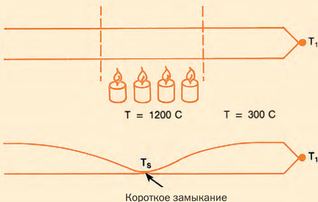
Рис. 18. Локальный нагрев термопары и изменение сопротивления
