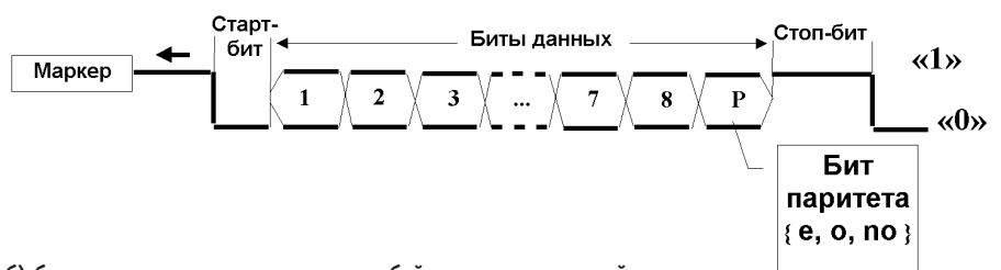
б) битовая структура передаваемого байта при асинхронной связи
