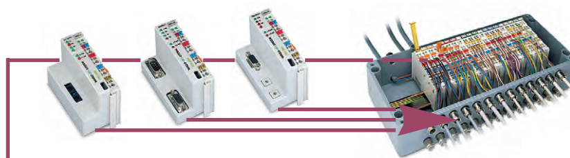
Контроллер WAGO I/O System. Для перехода на тот или иной CAN-протокол (CANopen, CAL или DeviceNet) достаточно установить соответствующий сетевой адаптер
