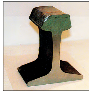
Рис. 8. Срез рельса с дефектом, обнаруженным АДС-02 в ходе испытаний
