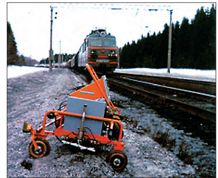
Рис. 3. Эвакуация дефектоскопической тележки при приближении поезда
