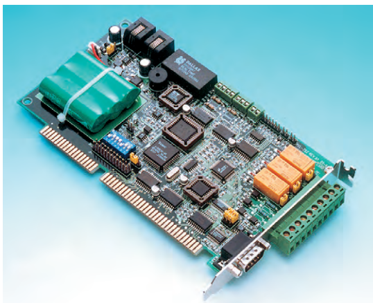
PCL-752 — программируемая плата мониторинга состояния вычислительной системы
