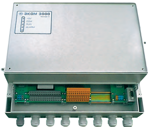
Рис. 3. ЭКОМ-3000 в компактном корпусе RegloCard фирмы Vorpla
