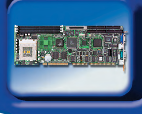
PCA-6178 Одноплатный промышленный компьютер на базе процессора Pentium III Socket 370
