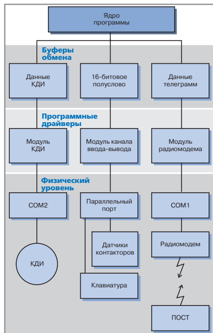
Рис. 9. Структурная схема программного обеспечения БА МАЛС
