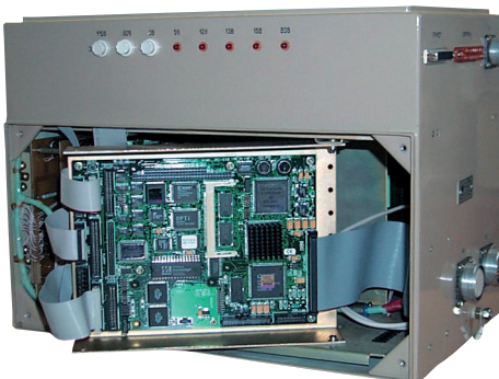
Рис. 7. Одноплатный компьютер PC-510 — основа бортового контроллера
