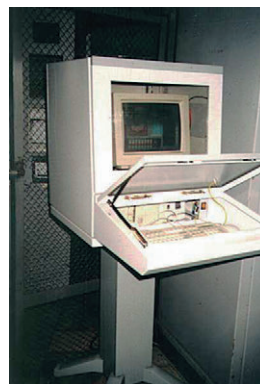
Рис. 3. Пылезащищенная стойка с аппаратурой комплекса
