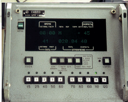
Одно из первых исполнений аппаратуры САВПЭ и её размещение в кабине машиниста электропоезда
