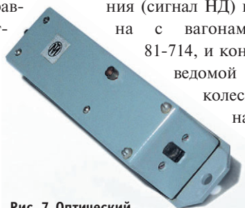
Рис. 7. Оптический ретрорефлективный датчик
