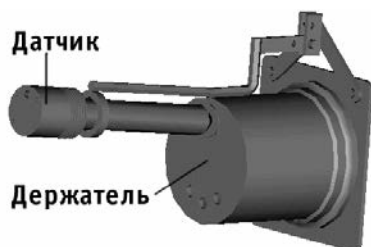
Рис. 4. Конструктивное исполнение держателя с датчиком
