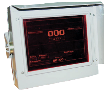
Рис. 8. Установка плоскочпанельного дисплея Planar в эргономичном конструктиве
