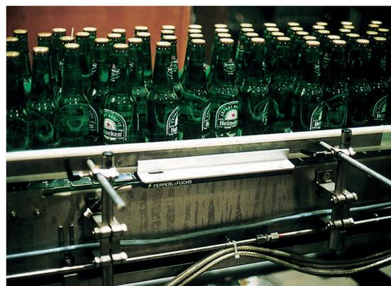
Фотоэлектрические датчики на заводах KRONES
