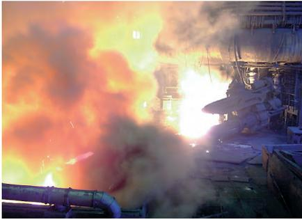
Рис. 5. Выпуск чугуна из доменной печи
