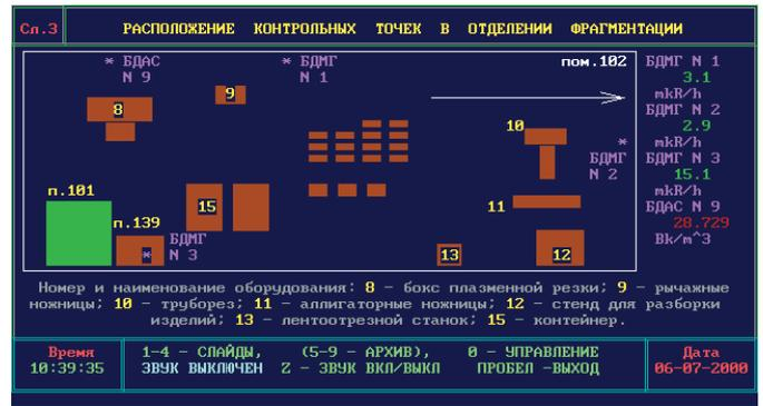
Рис. 2. Мнемосхема отделения фрагментации
