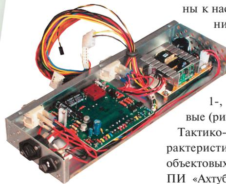
Рис. 5. Источник электропитания
