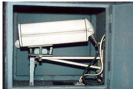
Рис. 4. Видеокамера в кожухе
