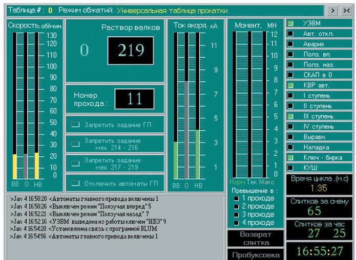
Рис. 11. Копия экрана программы оператора клетки 950
