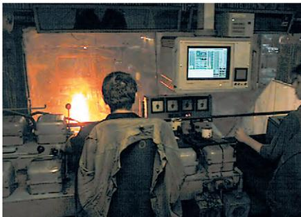
Рис. 8. Рабочая станция оператора первого поста клетки 950
