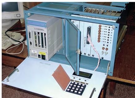
Рис. 9. Унифицированная блочно-модульная конструкция БОИ-7652М
