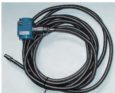
Рис. 2. Микропроцессорный температурный измеритель T7/MPX
