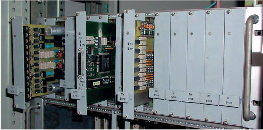
Рис. 6. Блок управления 10 огнями светофоров (БУСФ)
