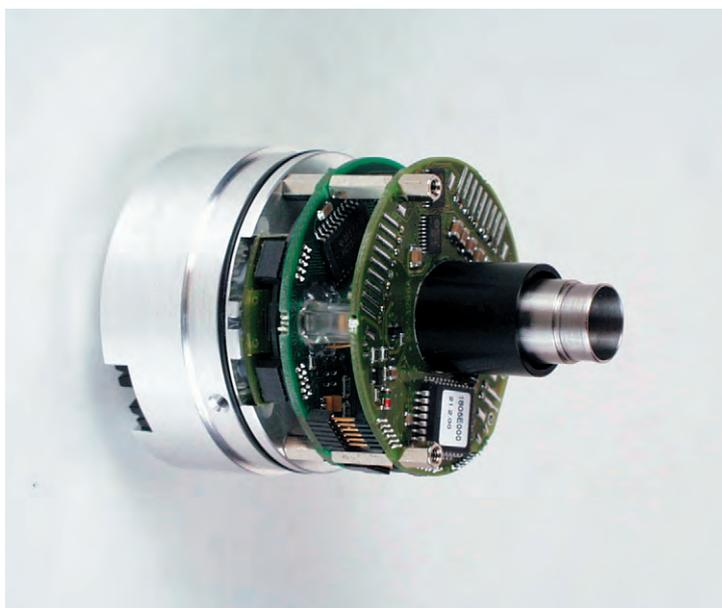
Внешний вид конструкции электронной части абсолютного шифратора
