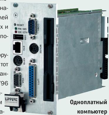
Одноплатный компьютер с шиной AT96
