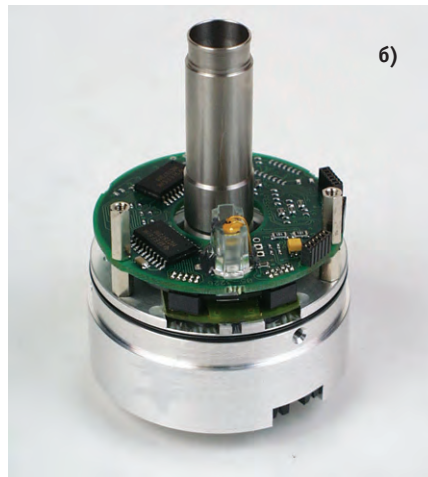
б) Плата схемы светодиодов; здесь же размещены регистры для «защёлкивания» данных
