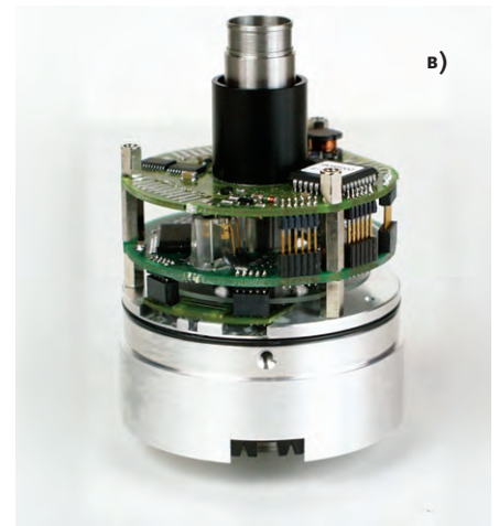
в) Верхняя плата включает в себя EEPROM для хранения программы, выходные схемы, цепи питания
