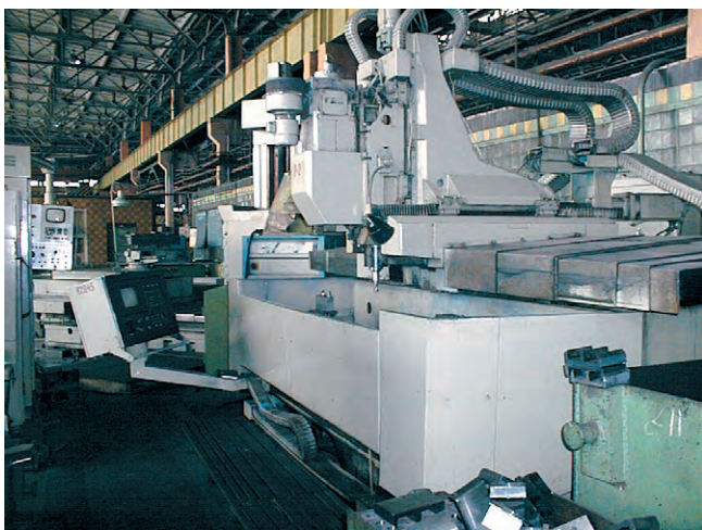
Рис. 1. Большие габариты и наличие подземных коммуникаций затрудняют демонтаж металлообрабатывающих станков
