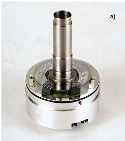
а) Кодированный диск и специализированная интегральная микросхема (ASIC) установлены и отъюстированы с микронной точностью
