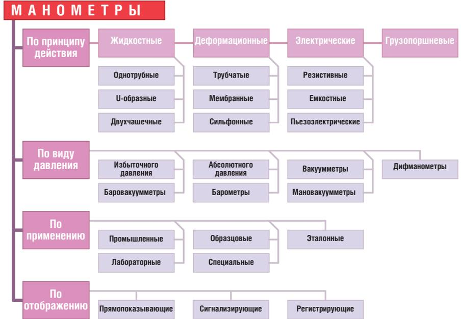
Рис. 3. Классификация манометров
