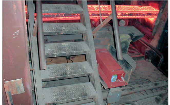
Рис. 6. Расположение оптического измерителя на МНЛЗ
