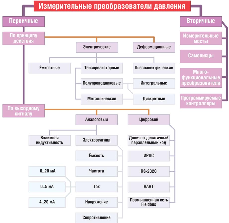
Рис. 4. Классификация измерительных преобразователей давления
