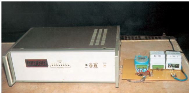
Рис. 2. Измерительный блок ДВО-2, модуль ADAM-4012 и радиомодем
