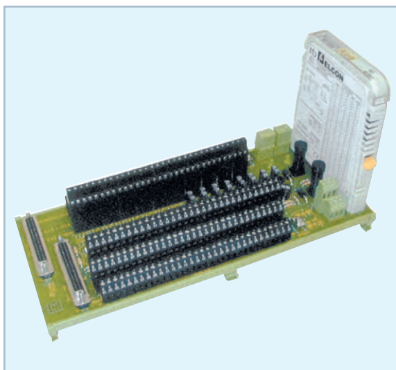
Рис. 7. 32-канальный HART-мультиплексор MUX 2700A с интерфейсом RS-485
