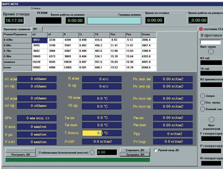
Рис. 7. Окно системы визуализации в режиме снятия дроссельной характеристики ГТД
