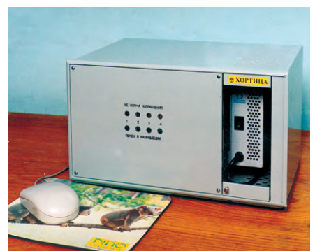
Рис. 3. Внешний вид контроллера связи
