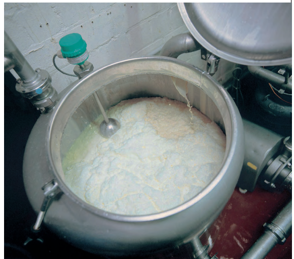
Рис. 15. Пример использования магнитного погружного зонда
