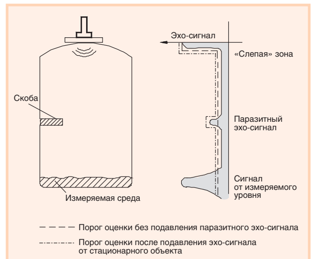
Рис. 8. Подавление эхо-сигнала от стационарного объекта в резервуаре
