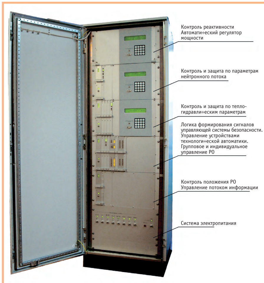
Рис. 4. Конструктивное исполнение стойки УНО (интегрированного канала формирования сигналов управляющей системы безопасности исследовательского реактора)
