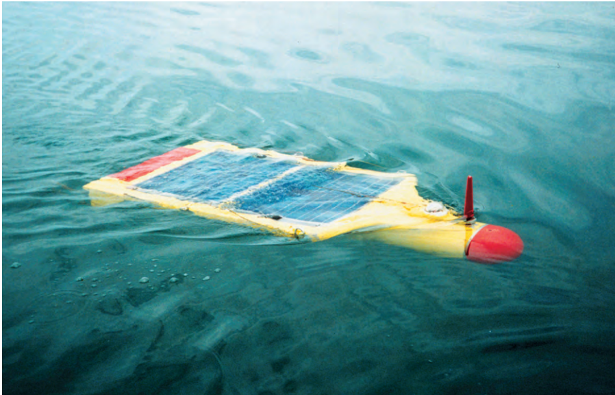
Рис. 3. Солнечный АПР на поверхности во время подзарядки аккумуляторов
