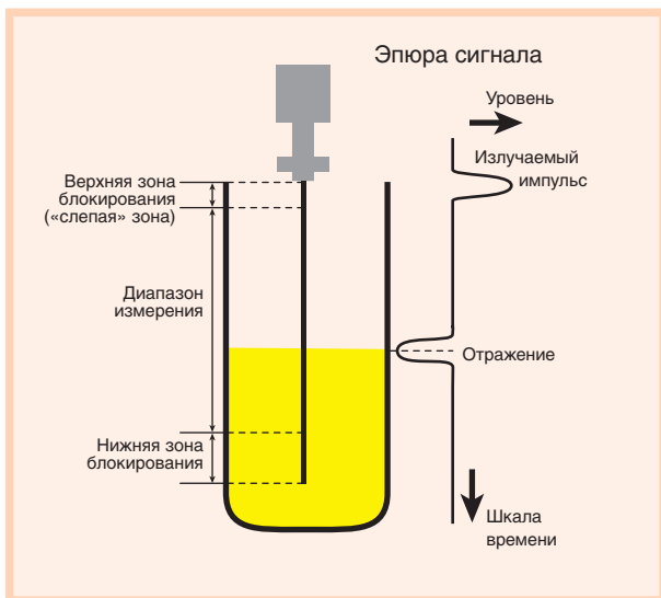
Рис. 11. Принципы измерения методом направленного электромагнитного излучения
