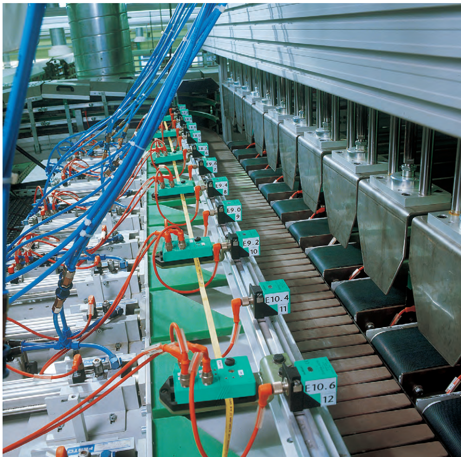
Рис. 1. Оборудование сети AS-интерфейса для конвейерной линии
