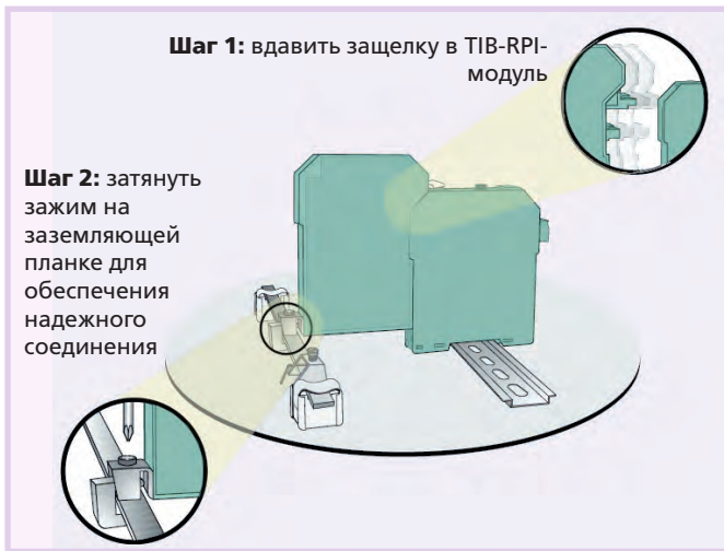
Рис. 9. Технология Snap-On: защёлкивание защитного модуля на передней панели установленного на DIN-рейке модуля К-системы
