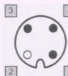
Рис. 8. Стандартизованное расположение контактов на разъёмах M12 модулей AS-интерфейса
