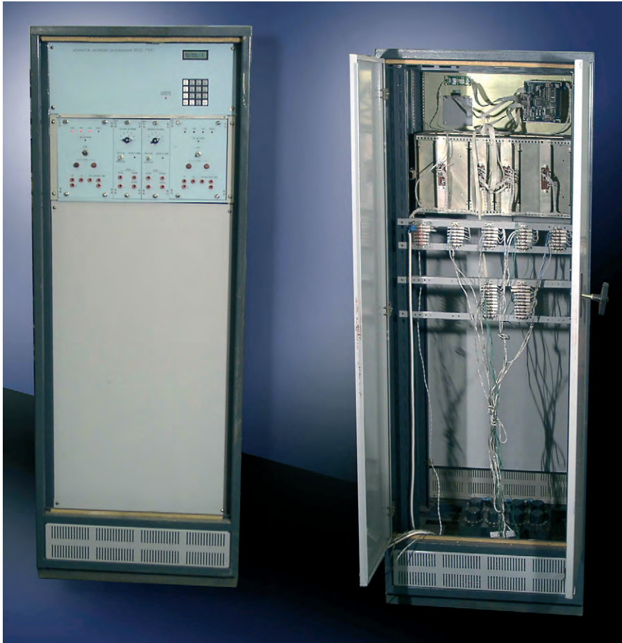
Рис. 4. Шкаф с аппаратурой комплекса ИНД-7681 (вид спереди и вид сзади)
