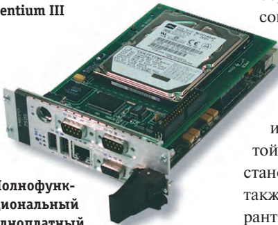
Полнофункциональный одноплатный компьютер VME на базе процессора Pentium III
