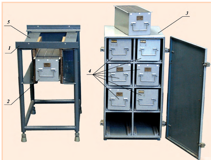
Условные обозначения: 1 — градуировочный стол; 2 — образец анализируемого материала; 3 — шкаф для хранения стандартных образцов зольности; 4 — стандартные образцы зольности; 5 — место установки ГДЗ-7683.
