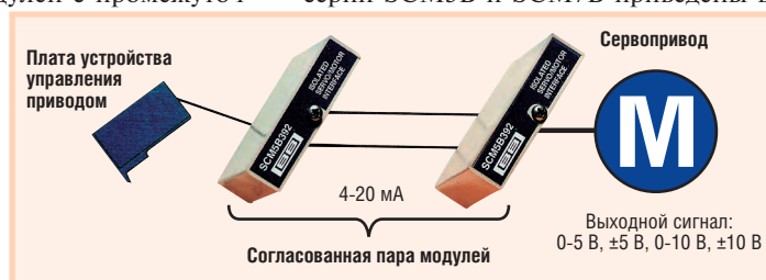
Рис. 3. Применение модулей SCM5B в цепи управления сервоприводом
