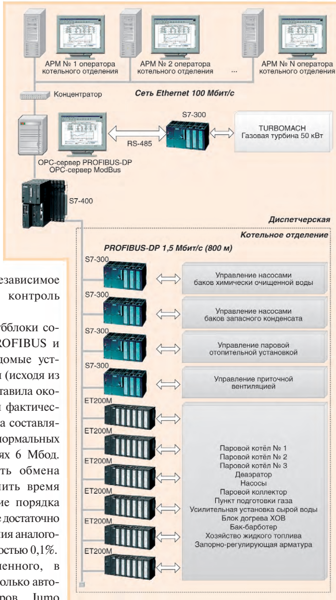
Рис. 1. Структурная схема КТС системы управления ТЭС «Балтика»
