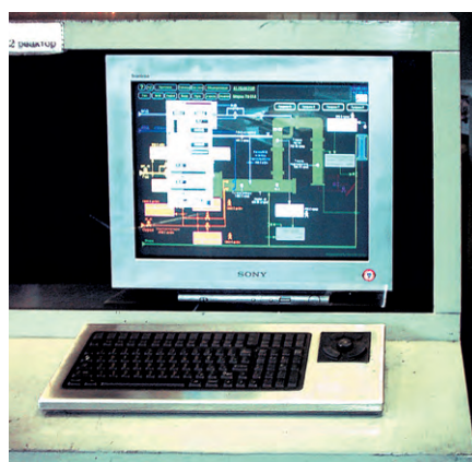
Рис. 6. Рабочая станция, укомплектованная защищённой промышленной клавиатурой с манипулятором DT-810 (Texas Industrial Peripherals)
