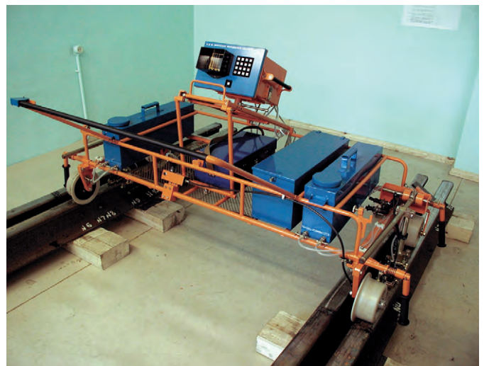
Рис. 5. Дефектоскоп с установленным на экран дисплея тубусом в сборочном цехе завода
