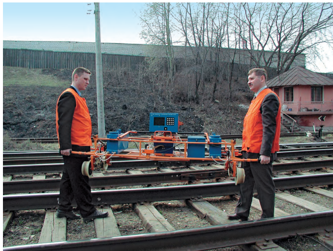
Рис. 2. Дефектоскоп АДС-02 на тестовых испытаниях
