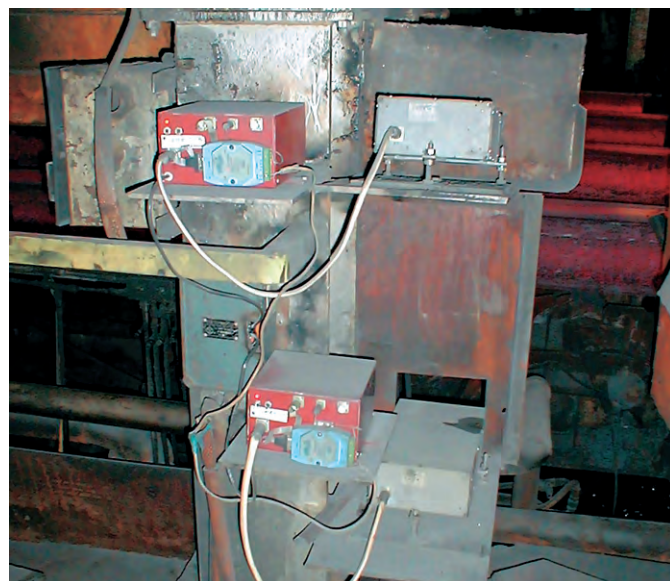
Рис. 4. Оптические измерители «РАСТР» на четырёхручьева МНЛЗ
