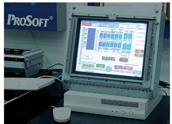
Рис. 4. Внешний вид модели LC12 (яркость 1500 кд/м<sup>2</sup>)
