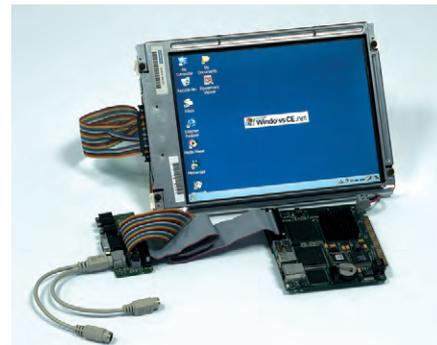
Рис. 11. Дисплей I-SFT 50i.M, работающий под управлением процессорной платы CPU686E фирмы Fastwel
