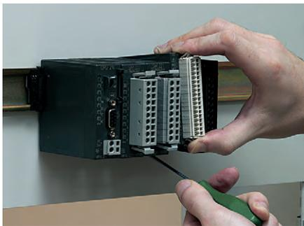
Рис. 8. Демонтаж модулей
