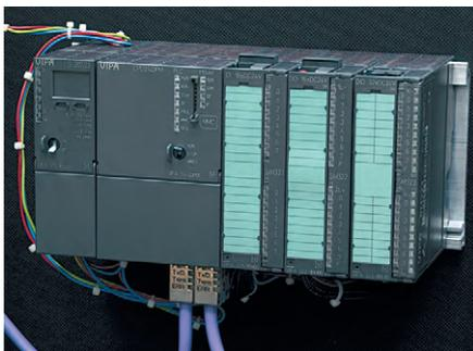
Рис. 2. Контроллер VIPA серии System 300V
