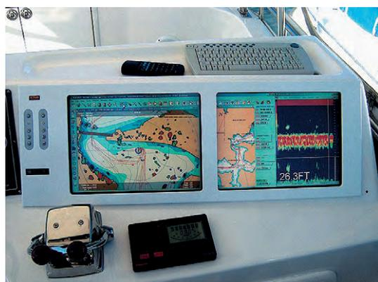
Дисплеи LiteMax в составе морской навигационной системы (при ярком солнечном освещении изображение на дисплеях остаётся чётким и контрастным)
