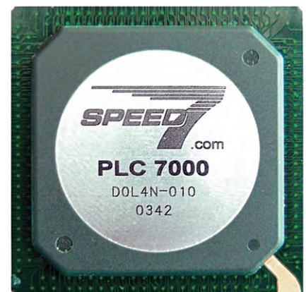
Рис. 4. Микросхема Speed7 фирмы ProfiChip
