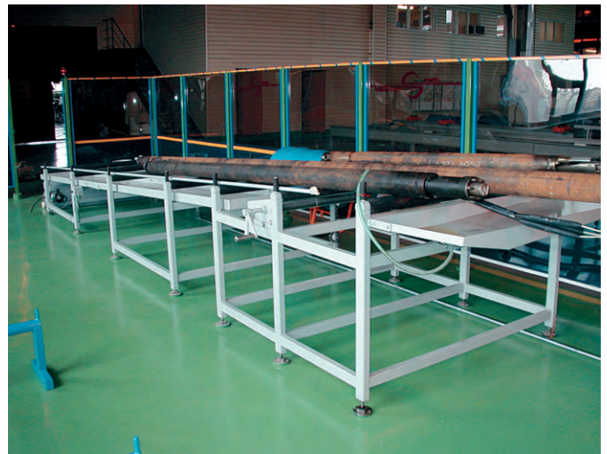
Рис. 7. Станина стенда тестирования ПЭД
