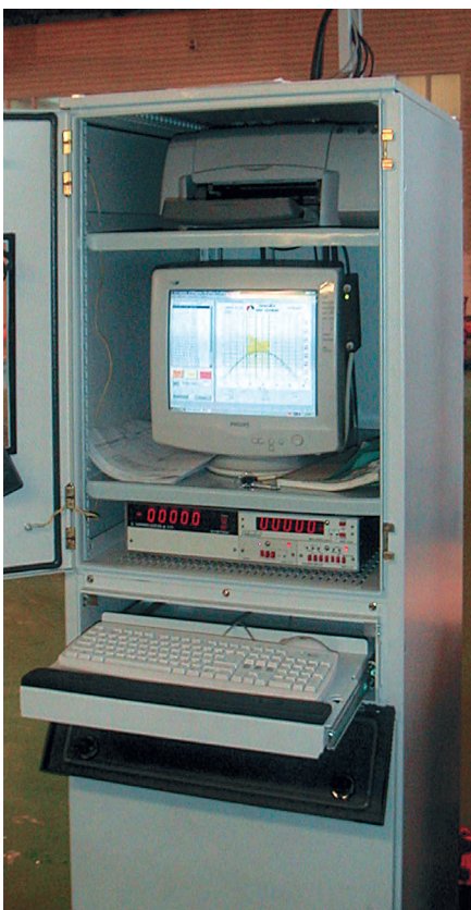
Рис. 3. Шкаф управления стенда тестирования ЭЦН
