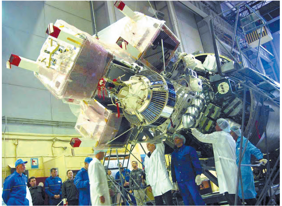
Рис. 3. МКА «Можаец-4» на второй ступени ракеты-носителя «Космос-3М»
