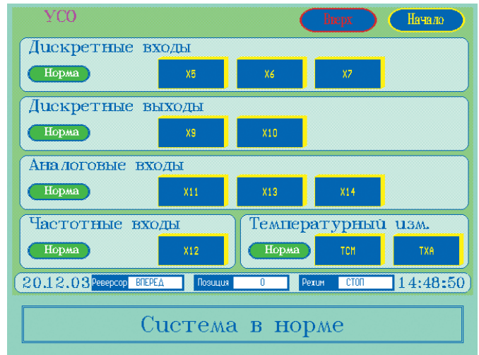
Рис. 13. Панель устройства связи с объектом
