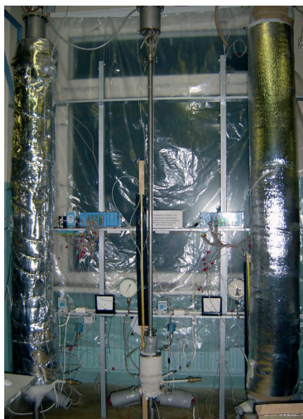
Рис. 1. Экспериментальный стенд из трёх ректификационных колонн (со средней колонны снята теплоизоляция)
