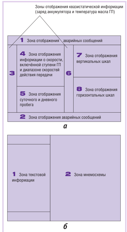
Рис. 7. Распределение областей отображения информации: а — для рабочего экрана, б — для диагностического экрана
