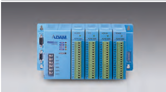
ADAM-5000/485 Система сбора данных и управления с 4 слотами расширения ADAM-5000E Система сбора данных и управления с 8 слотами расширения
