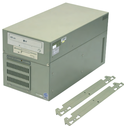
Компактная станция оператора АСУ IPC-6806-SYS4-1
