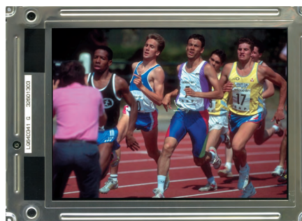
Рис. 2. Малогабаритный ЖК-дисплей LQ64D341, предназначенный для применения в составе автомобильной аппаратуры
