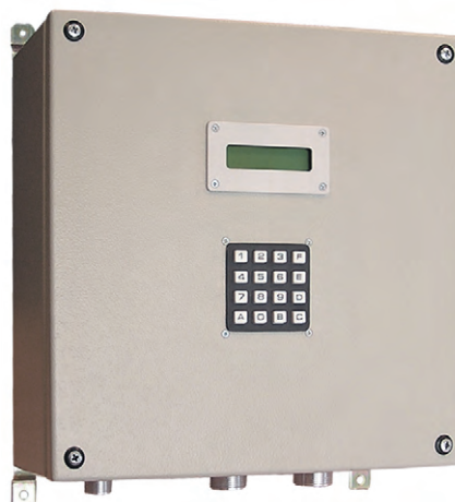
Рис. 11. Лицевая панель контроллера ПЕ2.781.001 системы ЦВА
