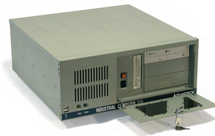
Станция оператора ACU IPC-510-SYS1-4
