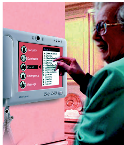
Рис. 3. Панельный компьютер фирмы Advantech в системе «умный дом»
