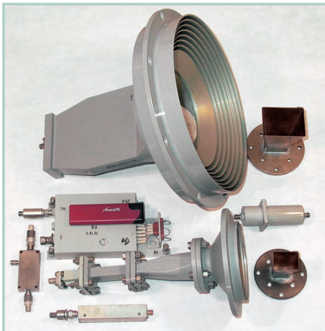
Рис. 2. Антенны и приёмники пеленгования
