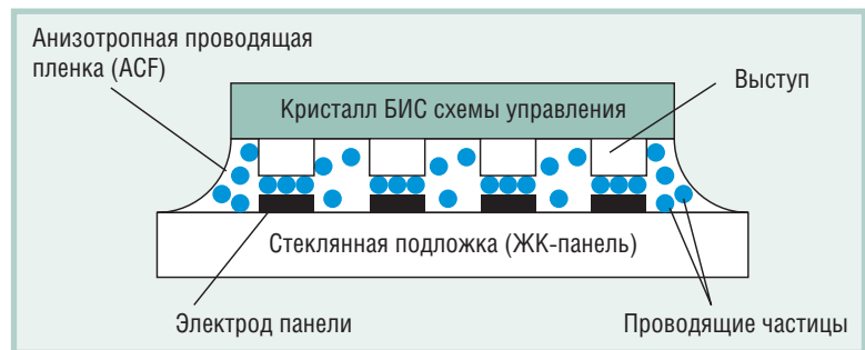
Рис. 12. Соединение ИМС управления и ячейки ЖК-дисплея по технологии COG
