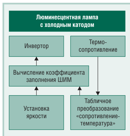
Рис. 11. Схема системы управления задней подсветкой
