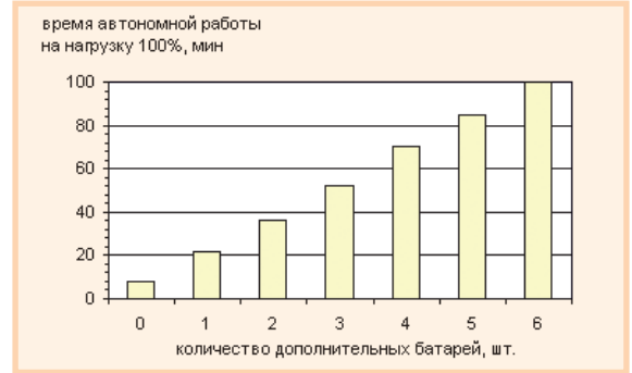
Рис. 6. Время автономной работы при установке дополнительных батарей
