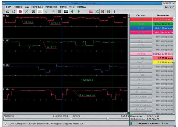
Рис. 8. Внешний вид окна программы «Осциллограф» непрерывной группы клетей 730
