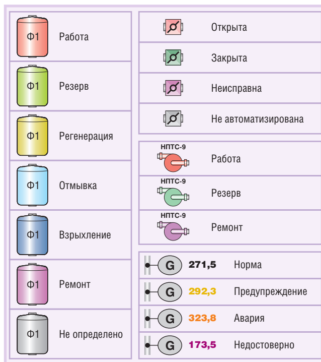
Рис. 7. Различаемые с помощью цветовой индикации состояния технологических узлов и характеристики значений измеряемых параметров
