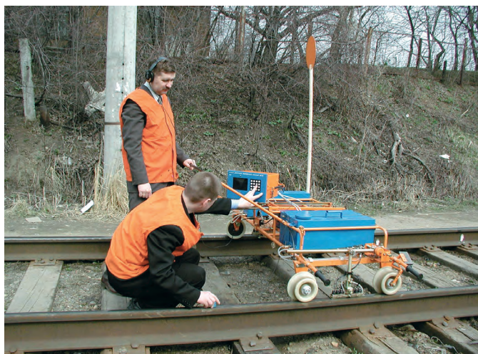
Съёмный рельсовый дефектоскоп АДС-02 в процессе испытаний (контроль сечения рельса ручным искателем)
