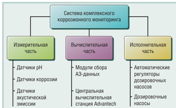
Рис. 1. Структурная схема системы комплексного коррозионного мониторинга
