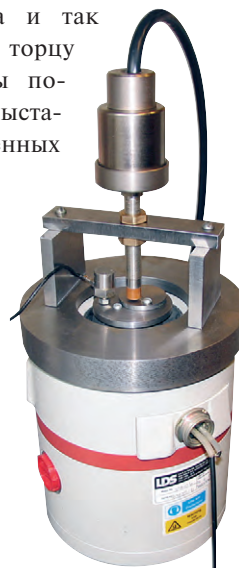
Рис. 5. Вибростенд с приспособлением для калибровки измерения виброперемещения датчиком ИВД-2
