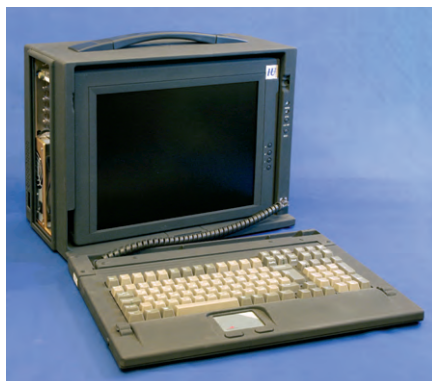
Рис. 7. Компьютер PWS-1409TP фирмы Advantech, используемый в качестве центральной вычислительной станции системы ККМ
