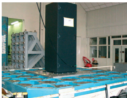
Рис. 5. Испытания шкафа на сейсмостойкость в лаборатории Sorretea (Париж)
