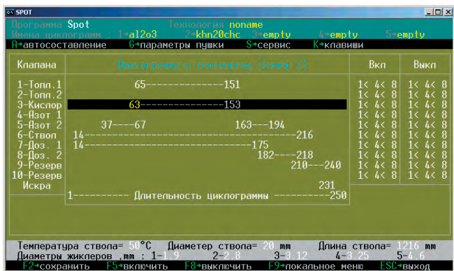
Рис. 7. Циклограмма режима напыления
