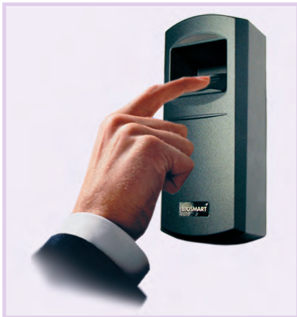
Рис. 1. Дактилоскопический считыватель отпечатков пальцев «BioSmart»
