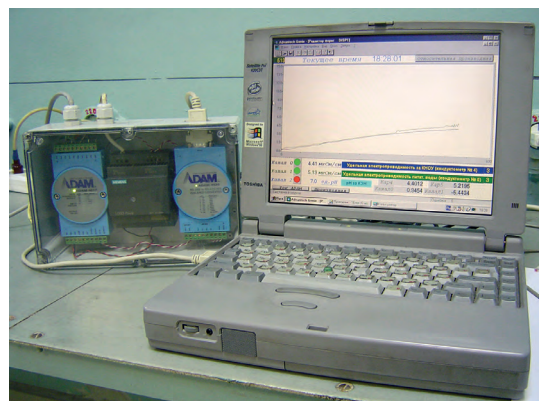
Рис. 3. Устройство связи с объектом и компьютер системы АХК
