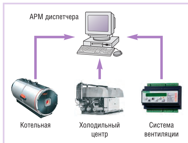
Рис. 1. Общая структура АСДУ инженерных сетей ТРК
