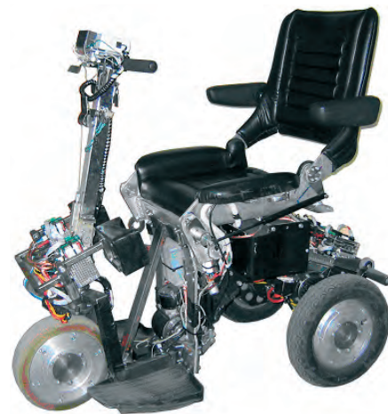
Рис. 7. Один из опытных образцов (ходовых макетов) транскутера
