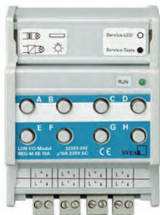
Рис. 10. Модуль ввода-вывода REG-M 8S 10A
