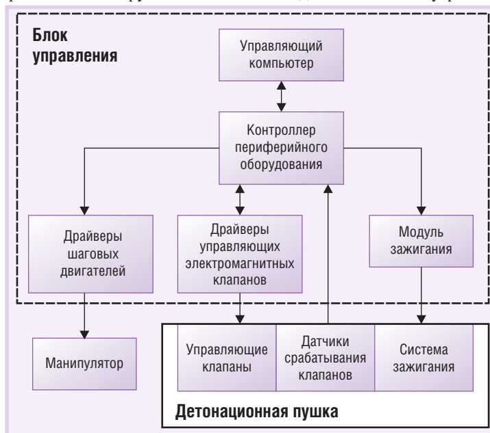
Рис. 6. Блок-схема системы управления
