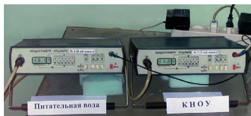
Рис. 2. Кондуктометры системы АХК
