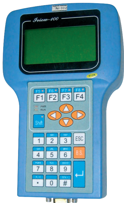
Рис. 4. Портативный контроллер, используемый в качестве программатора
