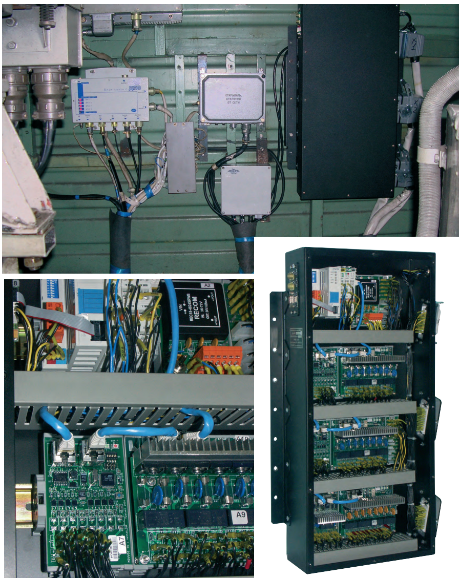
Рис. 5. Внешний вид модульного контроллера и специализированных модулей ввода-вывода для системы ЕКС-2 электровоза ЧС7
