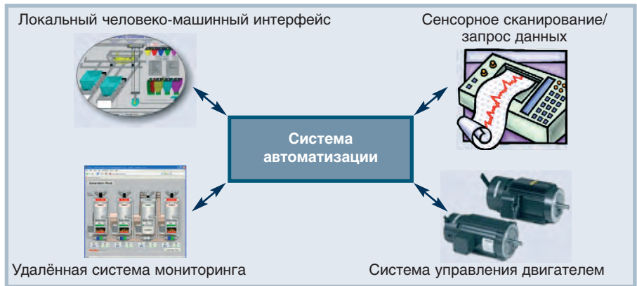
Рис. 2. Пример упрощённой системы автоматизации
