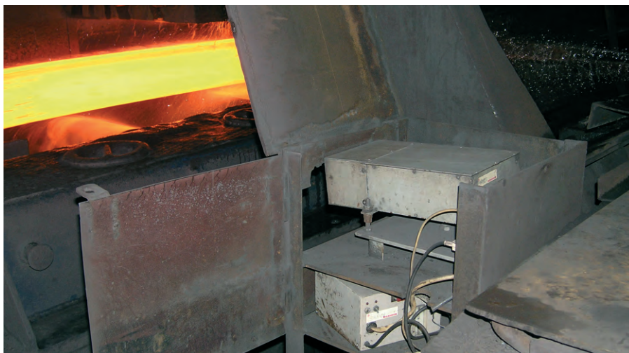
Рис. 5. Расположение оптического измерителя относительно подающего рольганга
