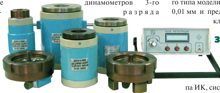
Рис. 6. Эталонные динамометры растяжения и сжатия
