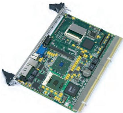
Рис. 4. Процессорная плата 6U CPC501 Fastwel
