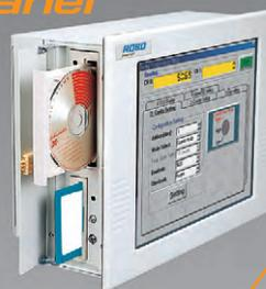
Основная конструктивная особенность панельных компьютеров iROBO Panel заключается в том, что в одном корпусе объединены промышленный компьютер и LCD-монитор. Размер компьютера по передней панели соответствует размерам стандартной LCD-панели, а толщина составляет всего 100-110мм. Это позволяет устанавливать такой компьютер как в панель, так и в 19" стойку.
