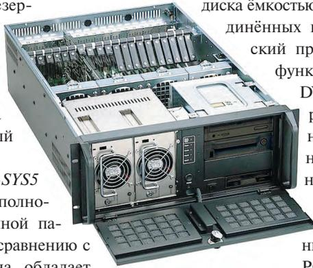
Рис. 7. Отказоустойчивый сервер технологического управления IS-SYS3
