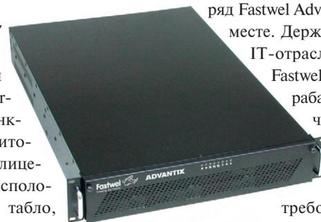
Рис. 10. 2U промышленный сервер с повышенной функциональностью IS-2U-SYS7
