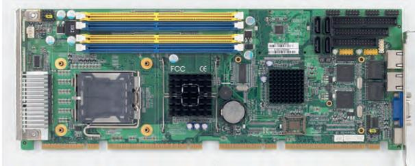
Рис. 4. Процессорная плата стандарта PICMG 1.3 Advantech PCE-5120
