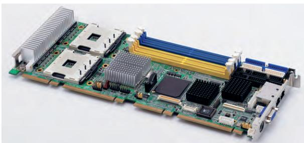
Рис. 5. Двухпроцессорная плата стандарта PICMG 1.3 Advantech PCE-7210
