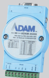
ADAM-45201 Преобразователь интерфейса RS-232 в RS-422/485
