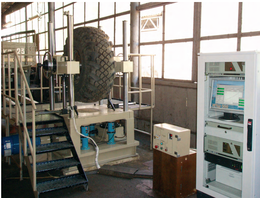
Рис. 1. Внешний вид стенда ИПШ-500
