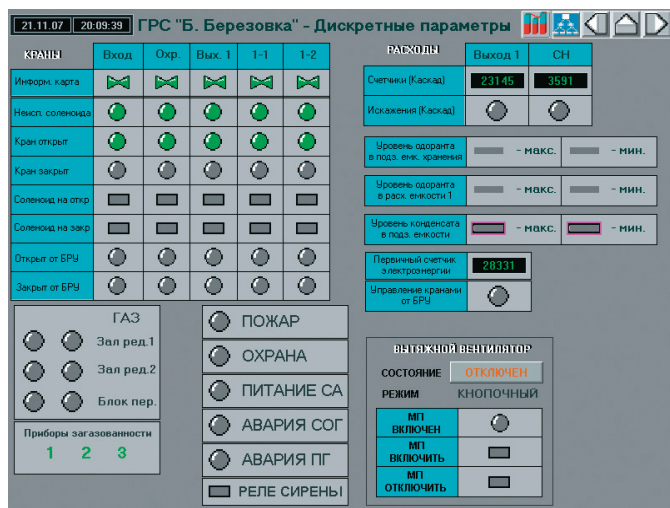
Рис. 7. Мнемосхема дискретных точек ввода-вывода САУ ГРС
