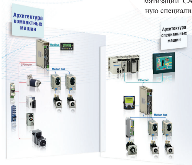
Рис. 2. Структура построения систем на базе Lexium Motion Controller
