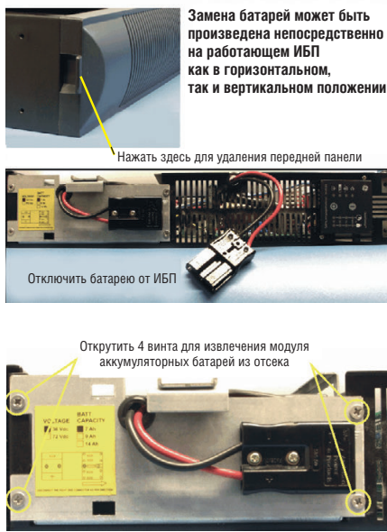
Рис. 11. Замена аккумуляторных батарей
