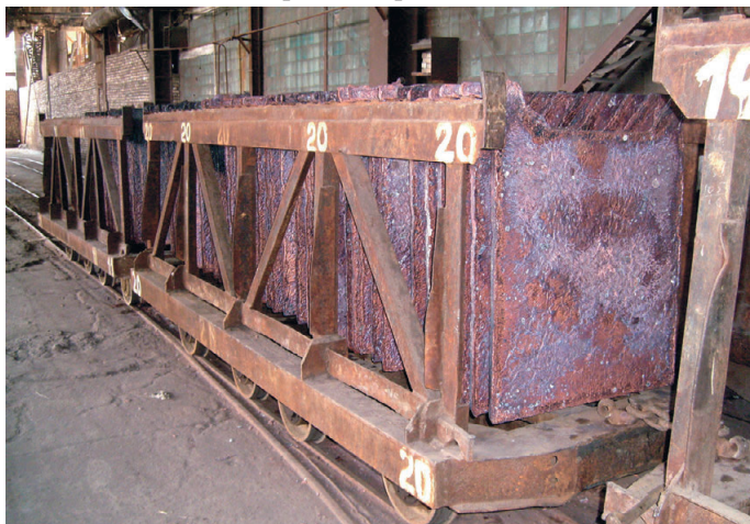
Рис. 6. Готовые аноды направляются в цех электролиза
