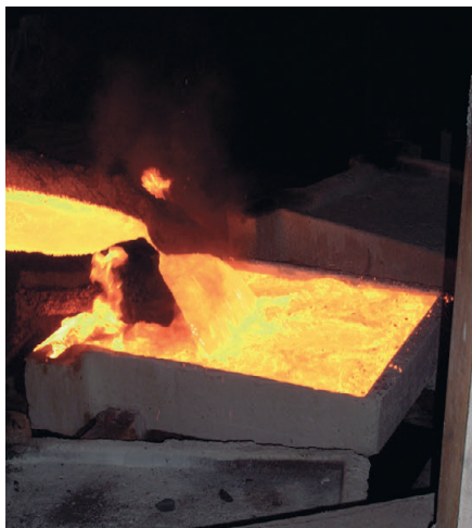
Рис. 4. Так отливается анод (заполнение изложницы медью)
