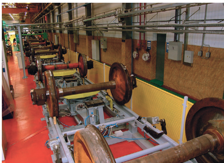
Рис. 8. Транспортёр перемещения колёсных пар
