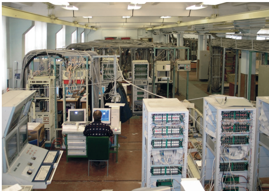
Рис. 2. Испытательный стенд, построенный на контроллерах фирмы Advantech
