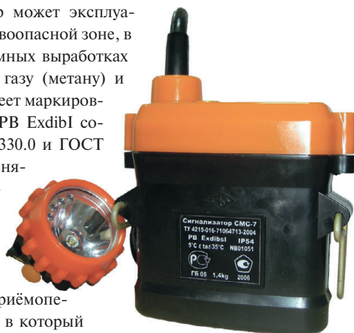
Рис. 3. Внешний вид сигнализатора метана СМС-7
