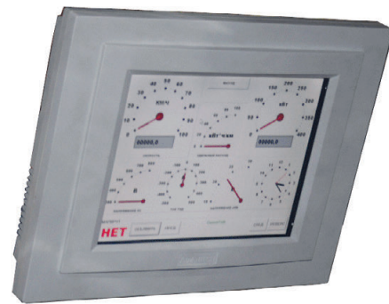
Рис. 1. Внешний вид панельного компьютера Advantech PPC-103T
