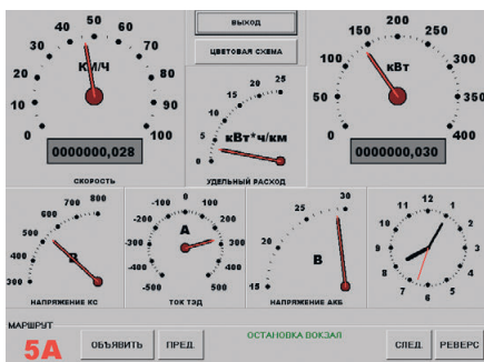
Рис. 4. Виртуальная панель приборов, отображаемая на экране компьютера
