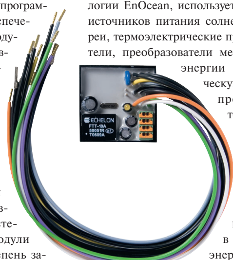
Рис. 13. Модуль ввода-вывода DI6UP с LON-интерфейсом
