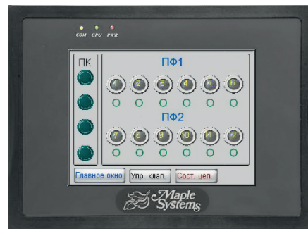
Рис. 7. Видеоклад ручного управления клапанами
