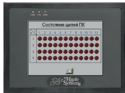
Рис. 6. Видеоклад диагностики электроцепей клапанов
