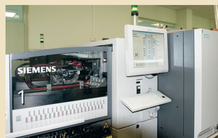
На производстве используется самая современная платформа Siplace X фирмы Siemens
