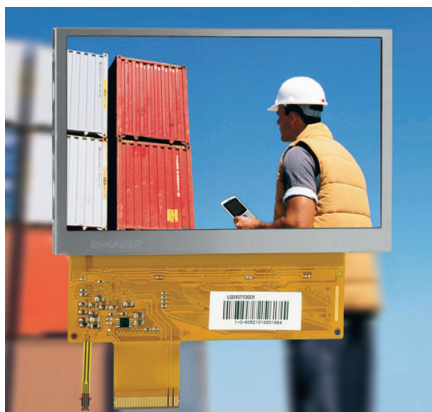
Рис. 10. ЖК-панель (размер диагонали 4,3") с устройством управления, предназначенная для применения в портативном промышленном оборудовании
