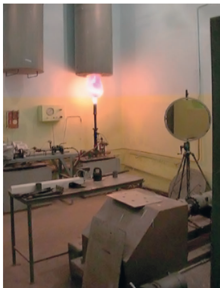
Рис. 6. Работающий макетный образец ПДД с эжекторным насадком
