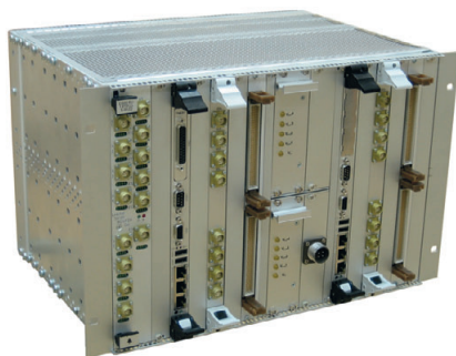
Рис. 5. Внешний вид крейта ЦВС с электронно-вычислительными средствами на базе шины сPCI 6U
