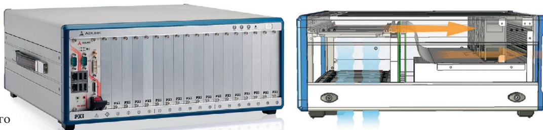
Рис. 12. Внешний вид шасси PXIS-2719 и схема охлаждения модулей внутри него
