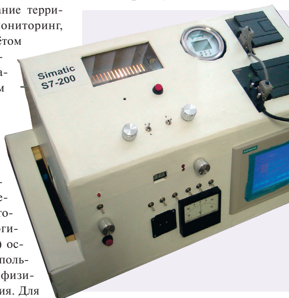
Рис. 9. Лабораторный стенд управления дискретным и непрерывным технологическими процессами на базе контроллера SIMATIC S7-224XP
