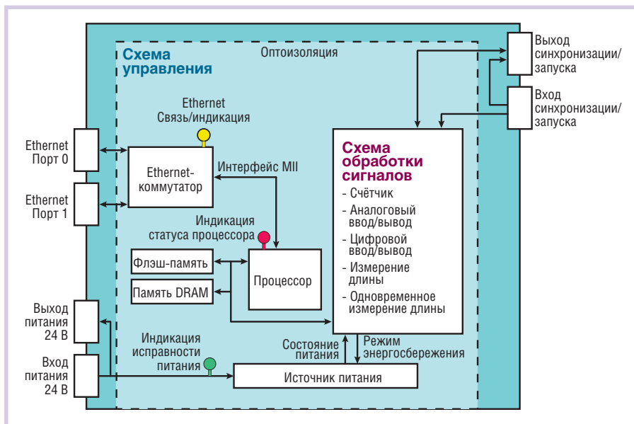
Рис. 2. Структурная схема интеллектуального Ethernet-модуля, реализующего коммуникационные функции, а также ввод-вывод и обработку сигналов
