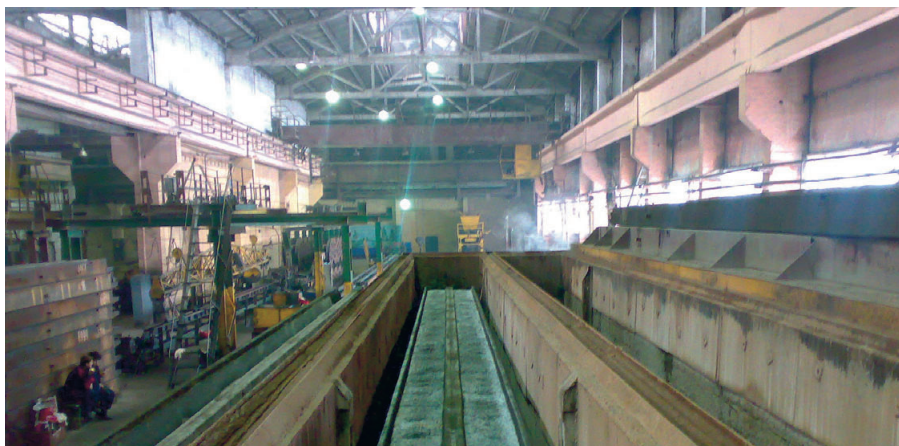
Рис. 2. Пропарочная камера (крышка снята, изделия загружены)
