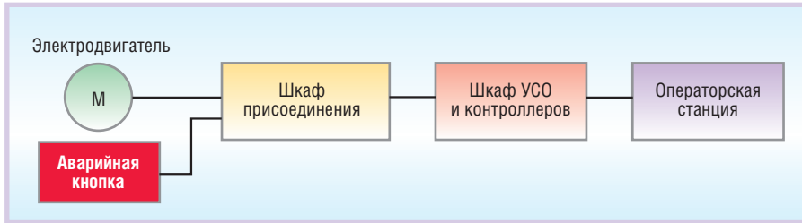
Рис. 1. Типовая структура цепей управления электродвигателем
