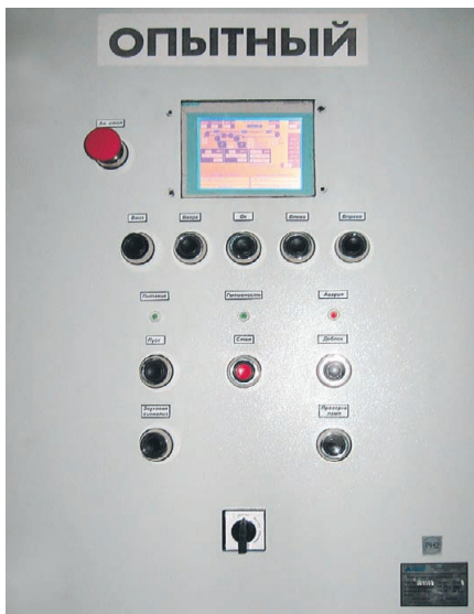
Рис. 3. БУК магистрального конвейера с частотно-регулируемым приводом
