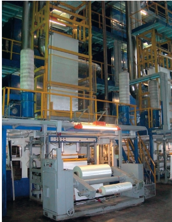
Рис. 7. Пиноль размотки, стол склейки полотна и магазин запаса
