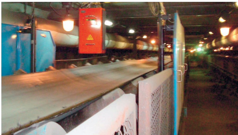
Рис. 3. Рудоконтролирующая станция, установленная на конвейере
