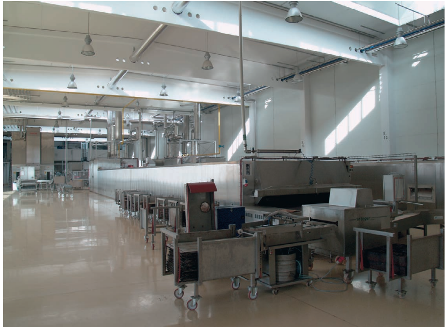
Рис. 1. Туннельная хлебопекарная печь, установленная в одном из цехов завода в Маркграфнойзидле, работает под управлением ПЛК VIPA
