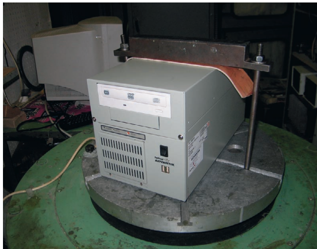
Рис. 22. Испытания AdvantiX ER УВМ1 на вибростенде
