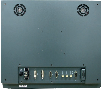
Рис. 6. Расположение вентиляционных отверстий на задней панели крупноформатного дисплея
