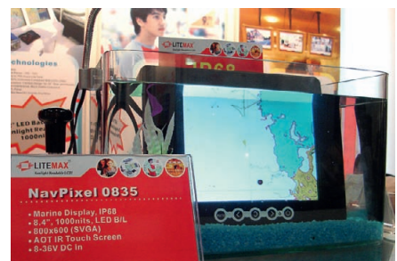
Рис. 5. Дисплей NPD0835, погружённый в воду, продолжает работать
