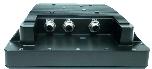
Рис. 4. Конвекционная система охлаждения NPD0835
