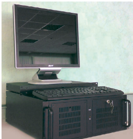
Рис. 6. Внешний вид аппаратной части системы цифрового приёма и обработки радиосигналов пассивной моноимпульсной радиолокационной станции
