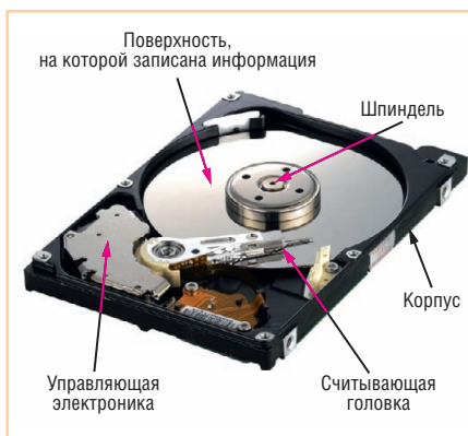
Рис 1. Конструкция НЖМД (со снятой крышкой)
