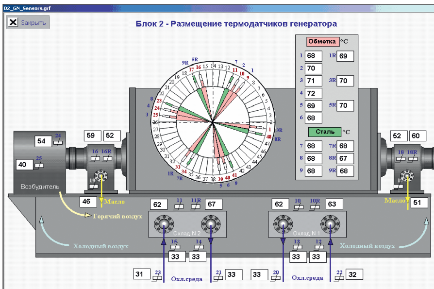
Рис. 8. Мнемосхема температурного контроля турбогенератора
