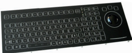
Рис. 9. Клавиатура с электролюминесцентной подсветкой KSTL105
