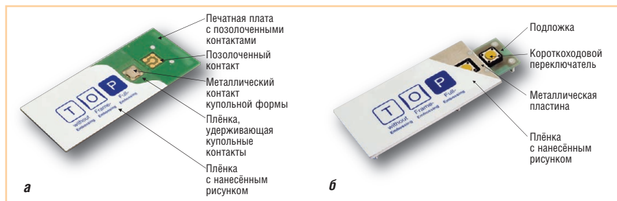
Рис. 1. Конструкция клавиатуры: а) мембранной; б) короткоходовой
