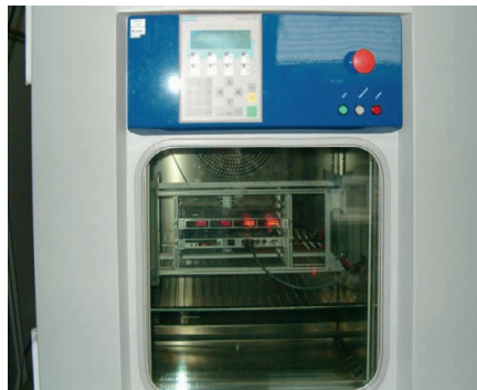
Рис. 5. Тестирование на устойчивость к воздействию климатических факторов
