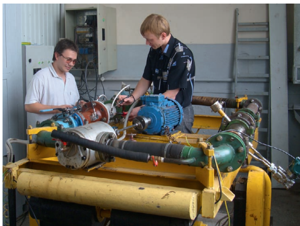
Рис. 12. Общий вид испытательной установки «Сател-УИВ» в процессе монтажа на ней зондирующего блока влагомера «Сател-РВВЛ»
