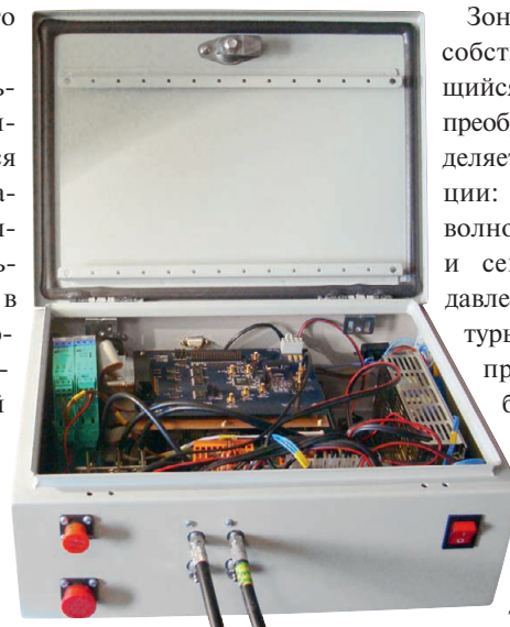
Рис. 9. Электронный блок влагомера «Сател-РВВЛ» с открытой крышкой
