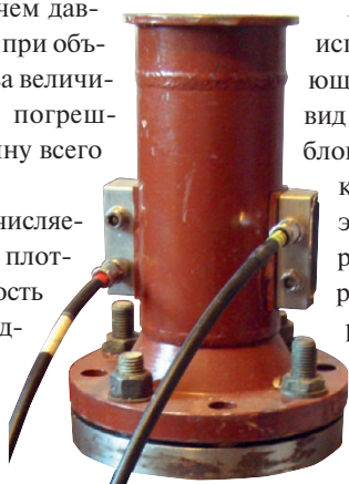
Рис. 8. Общий вид зондирующего блока влагомера «Сател-РВВЛ» с датчиками температуры и давления
