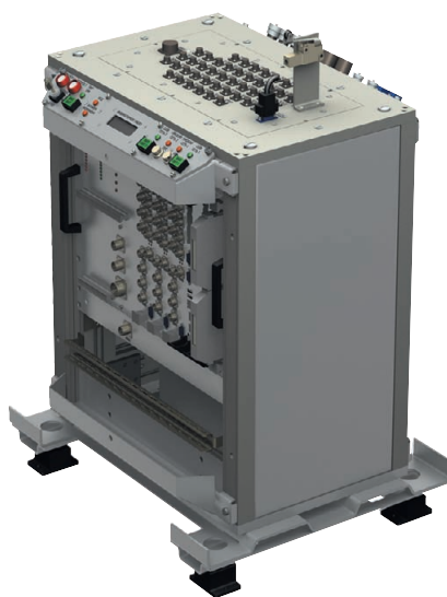
Рис. 4. Вид сервера со снятыми передней крышкой и верхним кожухом
