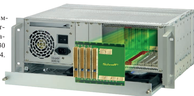
Рис. 7. Системный блок Schaffr с бекплейном PICMG 2.30 CompactPCI PlusIO
