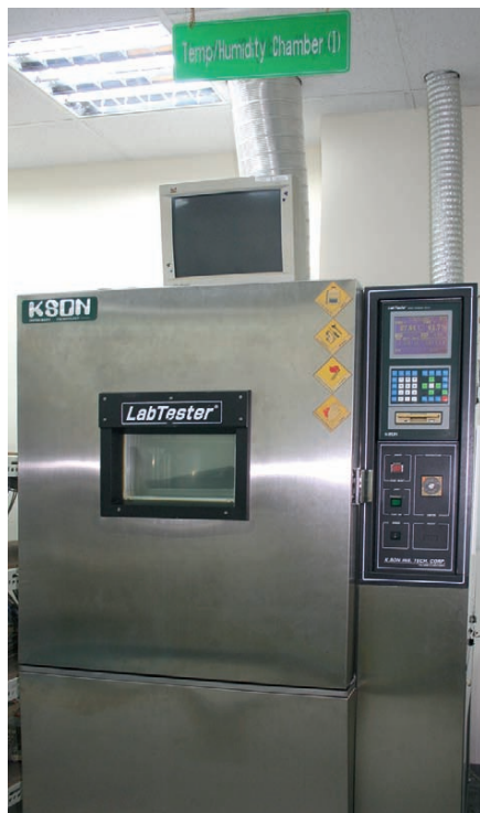
Рис. 2. Стенд для проведения температурного тестирования
