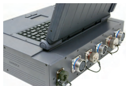
Рис. 6. Вариант доработки задней панели ноутбука A790
