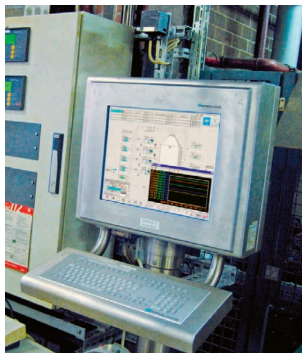
Рис. 2. Существует очевидная тенденция к децентрализации задач текущего контроля и управления. Визуализация технологического процесса непосредственно у установки становится обычным явлением
